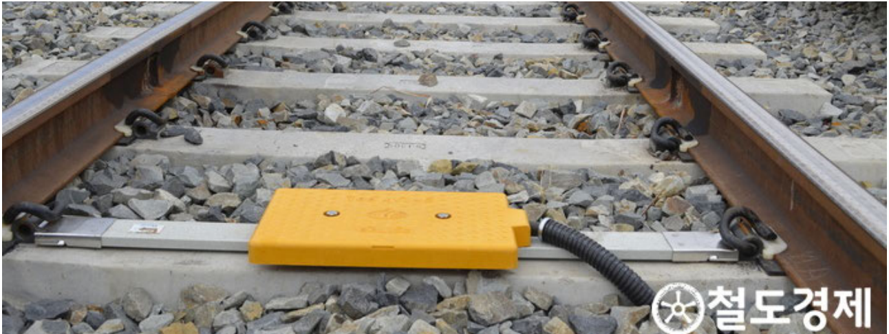
▲동해선 영천-신경주 구간에 설치된 ATP 지상자(발리스). 자료사진. / 철도경제
