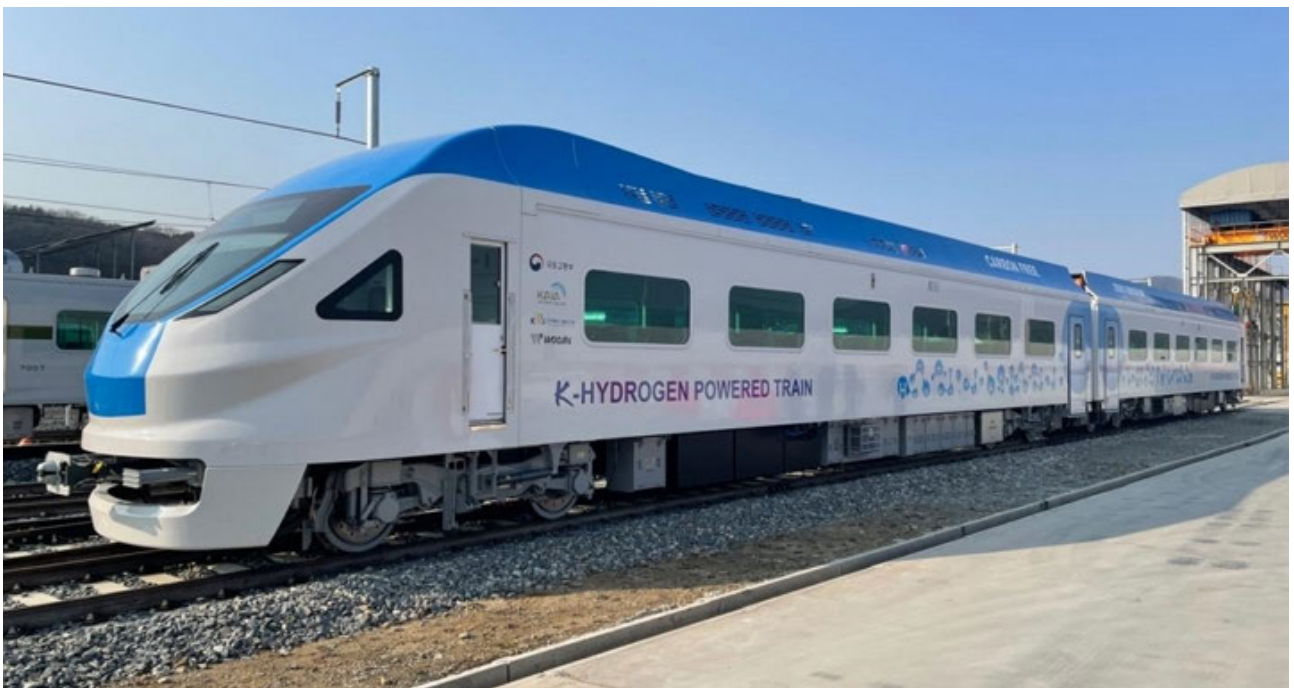
▲연구개발을 마친 수소전기동차. 2칸 1편성으로 최고속도 110km, 1회 충전하면 600km까지 운행할 수 있다. 올해부터 실증사업에 들어간다. / 사진=국토부
